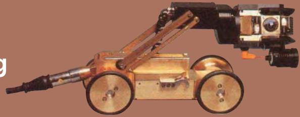
Roboter mit Spezialkamera (Fernauge)
