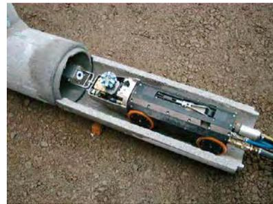
Fräsroboter mit Schwenkkamera
